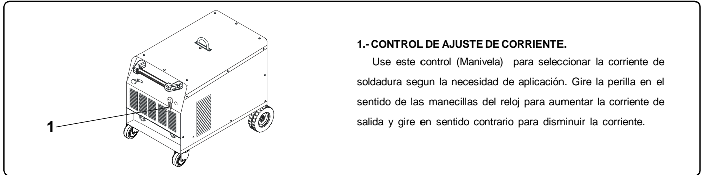
Figura 4-5 Control de Ajuste de Corriente
